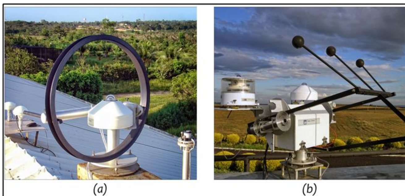
Figura 13- Sistemas de sombreamento para piranômetro usados na aquisição de dados de radiação difusa: anel de sombreamento (a) e esfera de sombreamento com rastreador solar (b).
