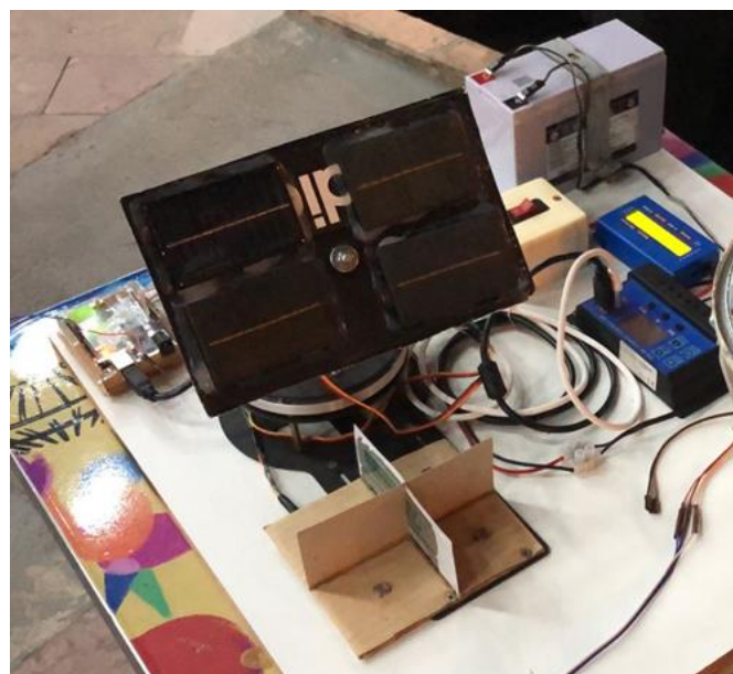
Figura 32-Protótipo de minissistema fotovoltaico acoplado a seguidor solar.
