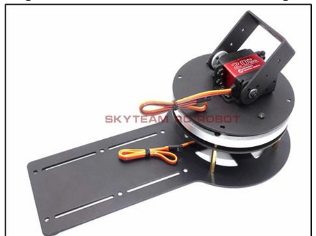
Figura 29-Base em metal com DSSERVOS 20kg.
