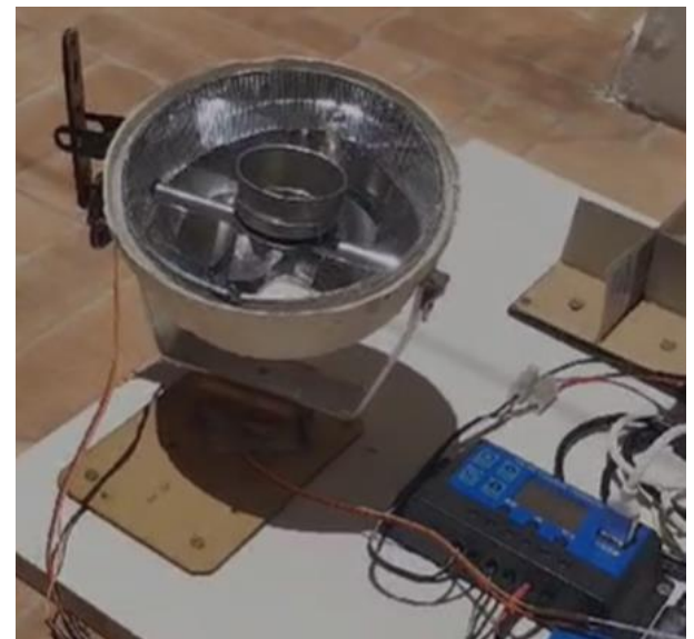
Figura 31-Protótipo de fogão solar acoplado a seguidor solar.
